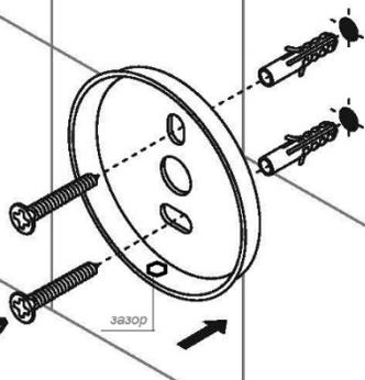
Совместите держатель с отверстиями на стене, установите дюбели и саморезы в подготовленные отверстия в стене. Убедитесь, что кронштейн установлен ровно, а зазор кронштейна находится внизу
