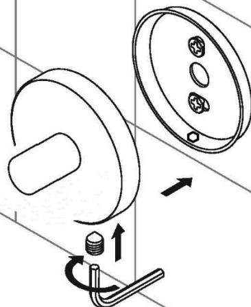
Закрепите изделие на кронштейне, используя шестигранный ключ затяните крепежный винт
