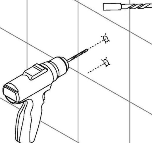
Дрелью и/или сверлом по бетону/плитке создайте два отверстия нужной глубины (по дюбелю) в местах отметки, в соответствии с положением отверстий монтажного кронштейна
